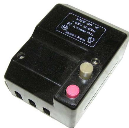
Выключатели автоматические серии АП-50 предназначены для эксплуатации в электроустановках для защиты от перегрузок и коротких замыканий электрических цепей напряжением до 220В постоянного тока, до 380В переменного тока частотой 50-60Гц, оперативных включений и отключений электрических цепей с частотой до 6 включений в сутки, а также для пуска, защиты и остановки электродвигателей.
