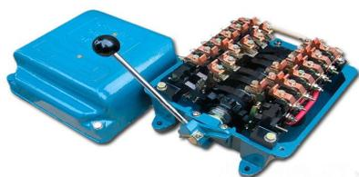
Контроллер серии ККТ является кулачковым, многоступенчатым, многоцепным аппаратом с ручным управлением, используется для изменения схемы главной цепи двигателя, цепи возбуждения, для изменения сопротивлений, включенных в эти цепи. Посредством ручного управления рукояткой контроллера осуществляется вращение вала и замыкание и размыкание контактов.
