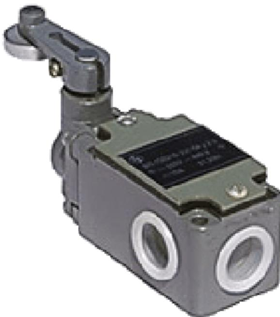
Концевые выключатели серии КУ-700 предназначены для коммутации цепей управления механизмов и применяются в качестве путевых. Выключатели КУ имеют две независимые электрические цепи и могут работать как на переменном, так и на постоянном токе в повторно-кратковременном режиме.
