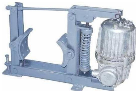
Тормоза колодочные гидравлические серии ТКГ предназначены для остановки и удержания валов механизмов (преимущественно подъемно-транспортных машин) в заторможенном состоянии при неработающем приводе.
