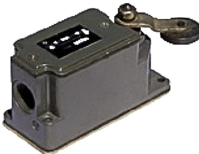
Выключатели конечные (ВК) предназначены для размыкания слаботочных сигнальных цепей (в электрических цепях управления, цепях сигнализации, цепях контроля положения различных подвижных частей механизмов) в зависимости от пространственного положения (позиции) рабочего органа управляемого электропривода.
