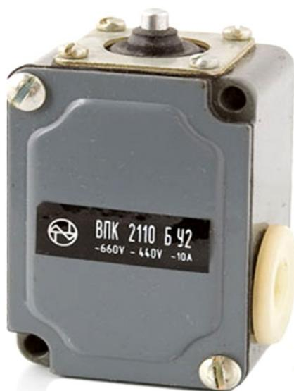
Выключатели путевые контактные (ВПК) предназначены для коммутации электрических цепей управления переменного напряжения до 660В, частоты 50(60)Гц и постоянного напряжения до 440В под воздействием управляющих упоров в определенных точках пути контролируемого объекта.
